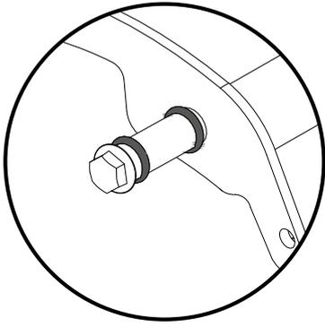
Bevor Sie die einzelnen Lamellen einlegen, achten Sie auf die Position der beiden Dichtringe. Wie im Detail gezeigt.
