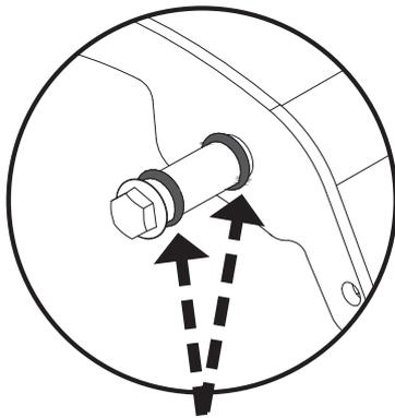
Bevor Sie die einzelnen Lamellen einlegen, achten Sie auf die Position der beiden Dichtringe. Wie im Detail gezeigt.
