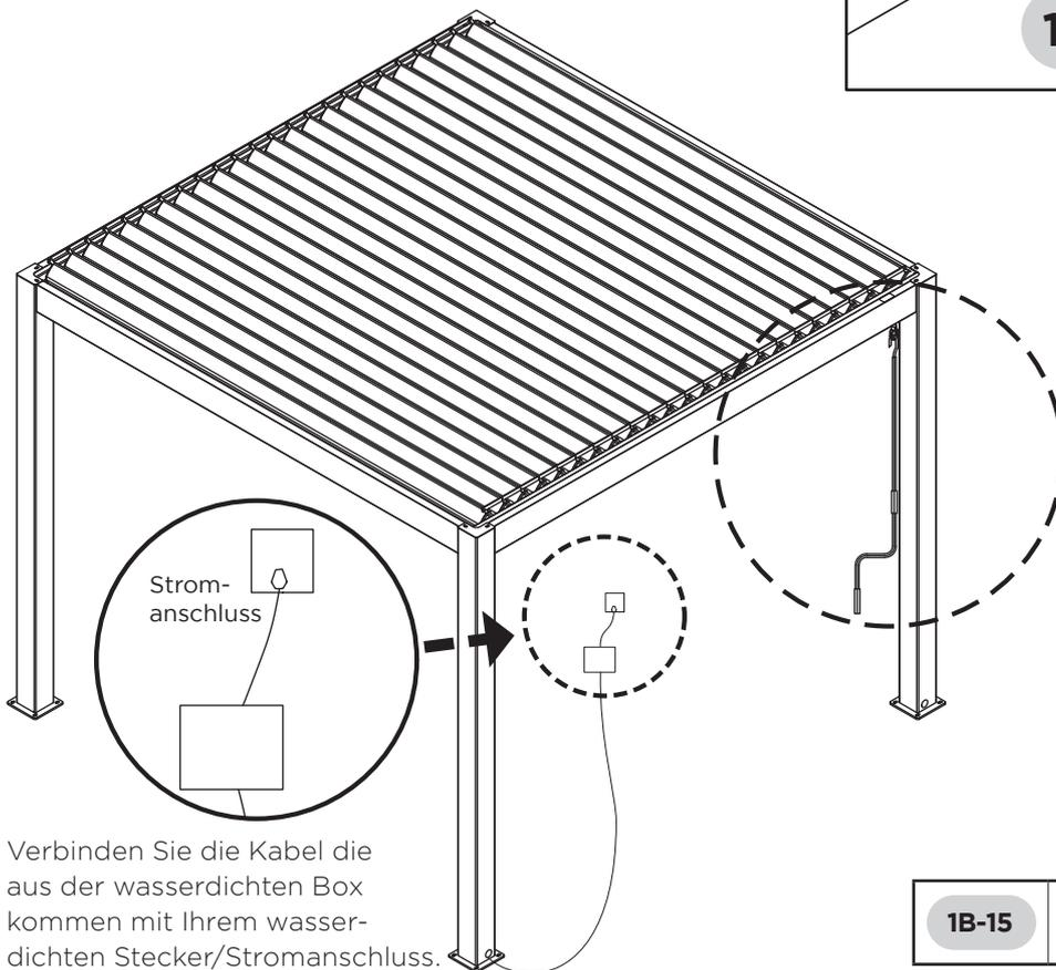
Verbinden Sie die Kabel die aus der wasserdichten Box kommen mit Ihrem wasserdichten Stecker/Stromanschluss.
