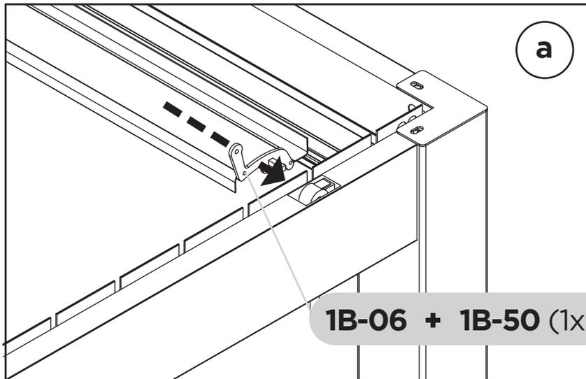
Bitte kappen Sie, vor dem Einlegen der Lamellen, beidseitige überstehende Gummidichtungen der einzelnen Lamellen. Max. Überstand 1 bis 2 mm auf jeder Seite.
